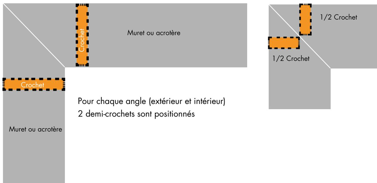
**Talon mural** > Axe du crochet positionné à 17 cm du mur.
