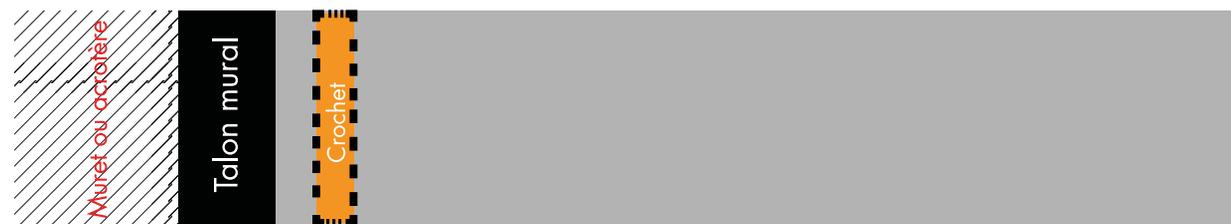
**Fond** > Axe du crochet positionné à 12 cm de l'extérieur du mur.
