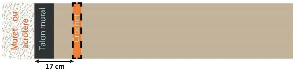
**Fond** Axe du crochet positionné à 12 cm de l'extérieur du mur.
